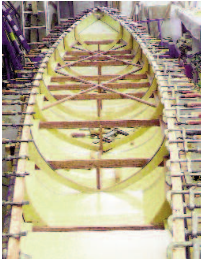
Abbildung 3: Single-Skin-C-Boot mit begehbarem Boden und Auftriebskammern im Bug- und Heckbereich. Foto: Rehberg
