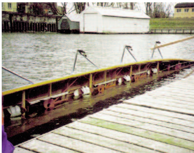
Abbildung 1: Flutungstest zur Auftriebs-Bestimmung bei Gigs. Foto: Schellenbacher
