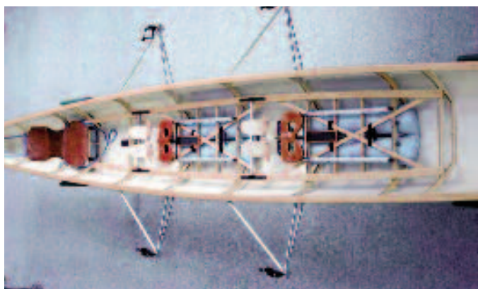
Abbildung 2: nachträglich eingebaute Auftriebs-Schläuche bei Gigs. Foto: Empacher
